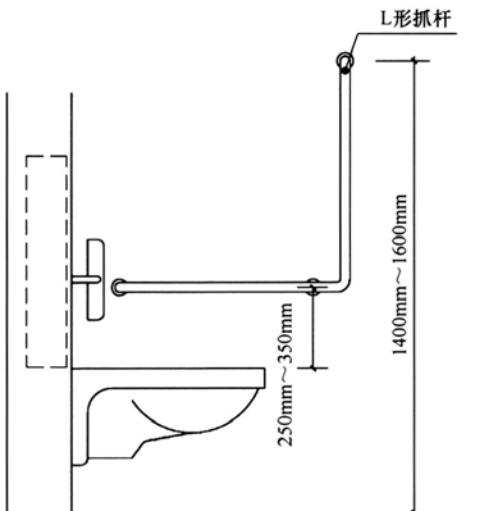
图 4 无障碍坐便器安全抓杆设置侧面图
