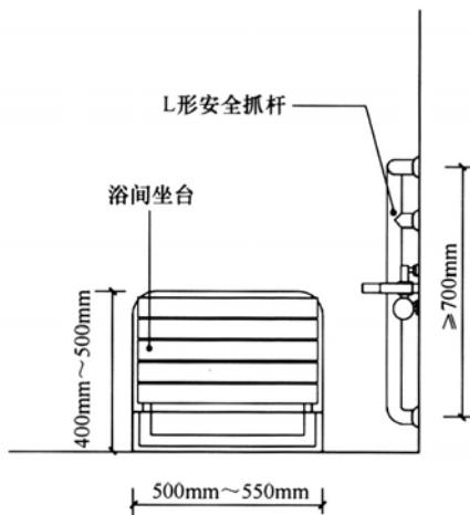
图8 无障碍淋浴间局部平面图
