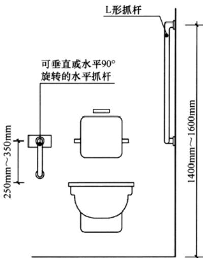
图 3 无障碍坐便器安全抓杆设置正面图
