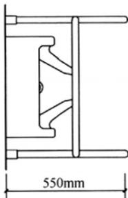
图5 无障碍小便器安全抓杆平面图
