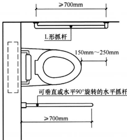
图2 无障碍坐便器安全抓杆设置平面图
